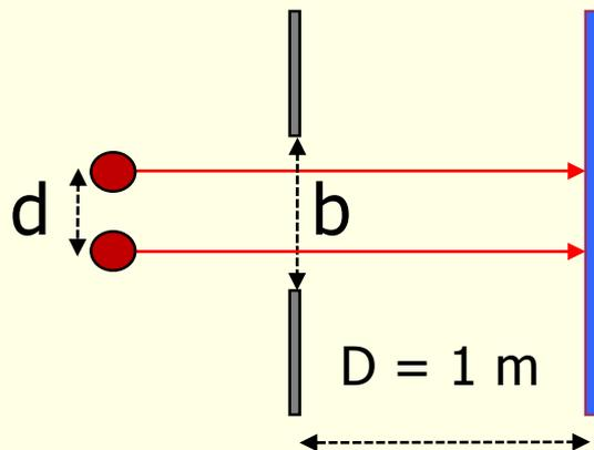
Ecran éloigné où se forment les images de 2 sources identiques de  $\lambda = 500 \text{ nm}$  après traversée d'une fente carrée de largeur  $b = 0,5 \text{ mm}$ .
