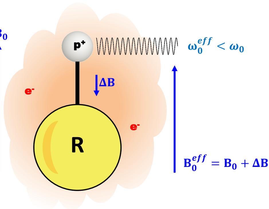
$$\text{Déplacement chimique : } \delta = 10^6 \frac{\omega_0^{eff} - \omega_0^{ref}}{\omega_0^{ref}} \text{ [ppm]}$$
