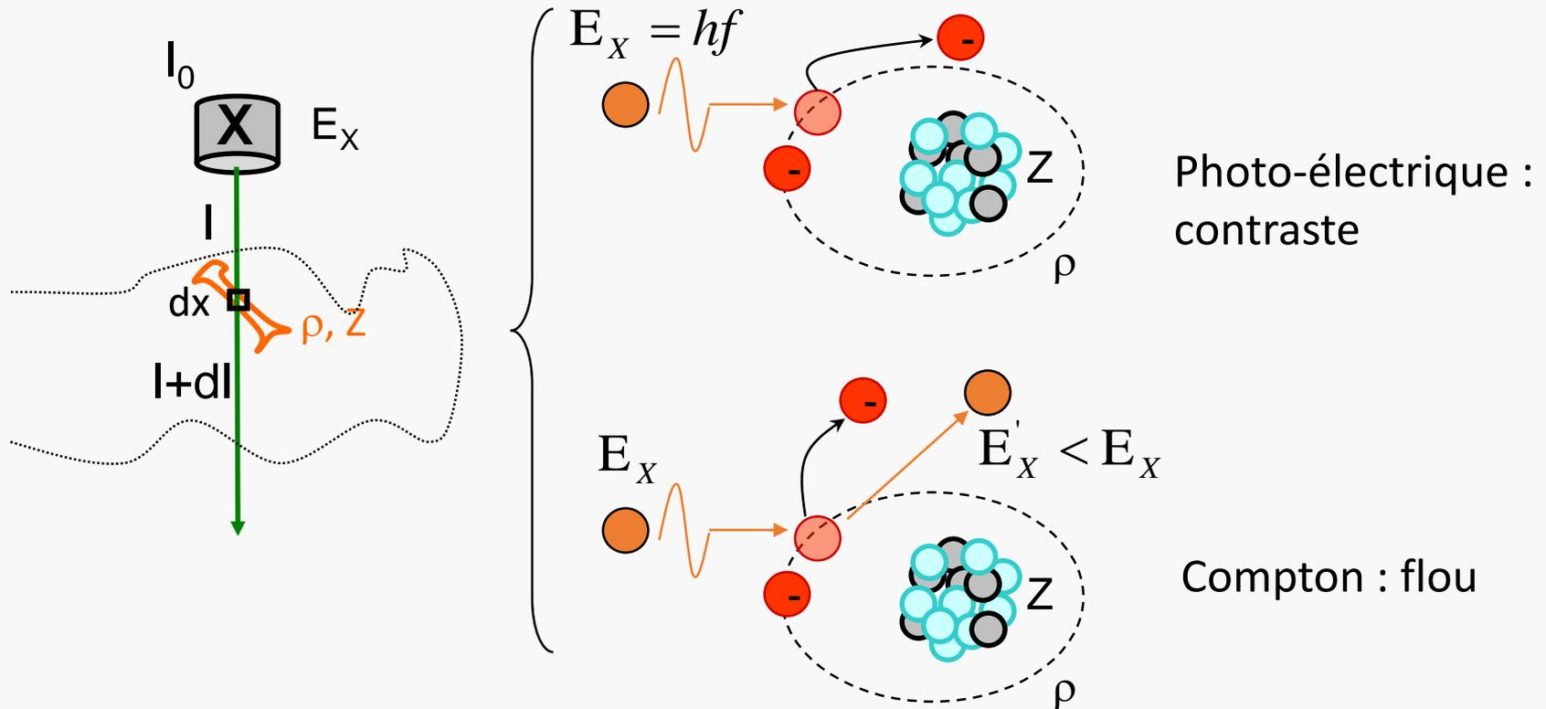
Interaction aléatoire  $\rightarrow$   $dl / I = - \mu dx$        $\mu =$  coef. linéique d'atténuation
