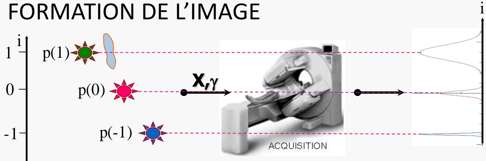
$$p(i) = \sum_{k=-\infty}^{+\infty} p(k) \cdot \underbrace{\delta(i-k)}_{= 0 \text{ sauf si } k=i \text{ où } \delta(0)=1}, \quad i \text{ fixé}$$
