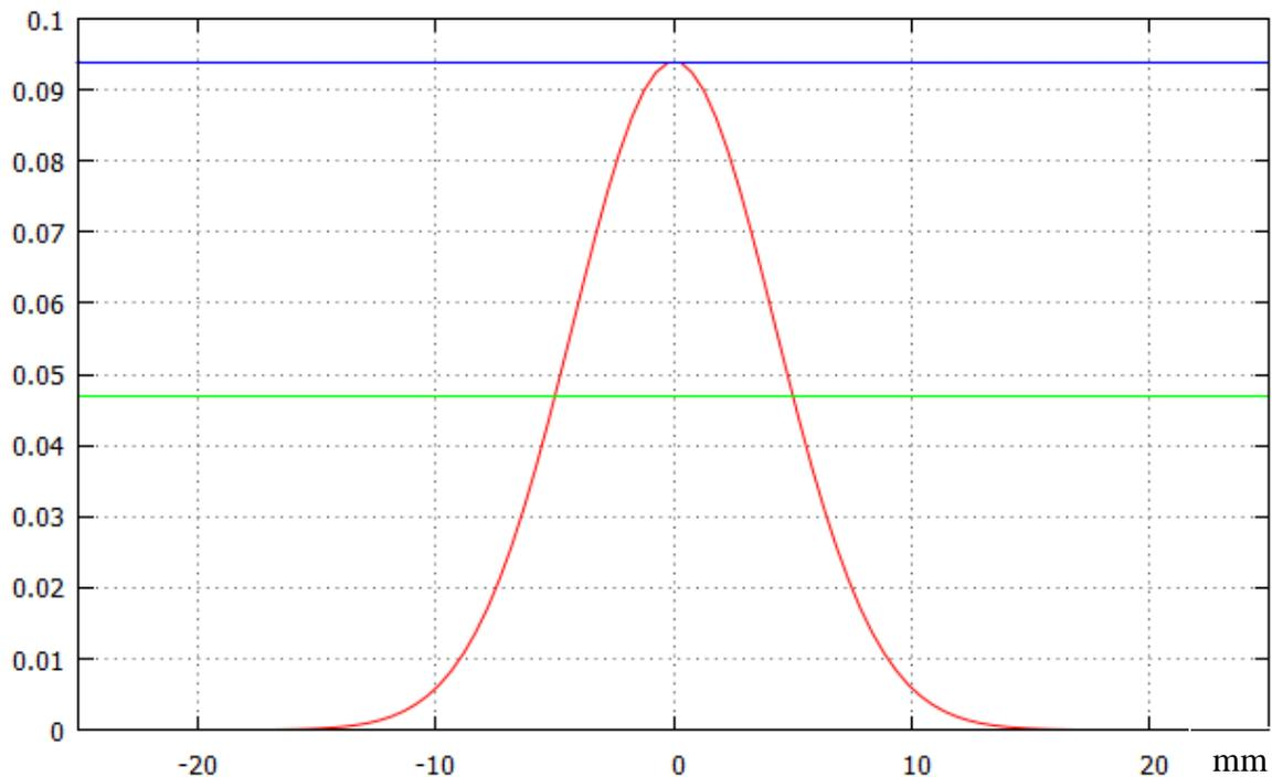
Réponse impulsionnelle mesurée à une distance de 15 cm dans de l'eau de la gamma caméra équipée d'un collimateur LEHR de réponse intrinsèque 4 mm
